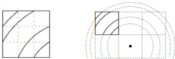
我们回头看看本节开始提到的第一个“不可能”的楔形榫头问题. 应用刚刚提到的几何构造, 我们看到上面左图给出这个问题的另外一个解, 它用圆形榫头代替直的榫头. 但还有一个不同的解, 用同心圆插入, 如下图所示. 需要围绕圆心旋转 45 度, 方能拨开两个木块.
