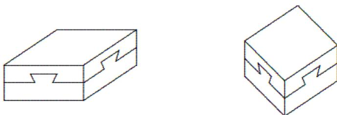
不经过挖洞，不用挤压，膨胀，润湿等把戏，用两块木块拼成这样的一个楔形榫头可能吗？下面我们通过纯几何的构造来寻找解答。
